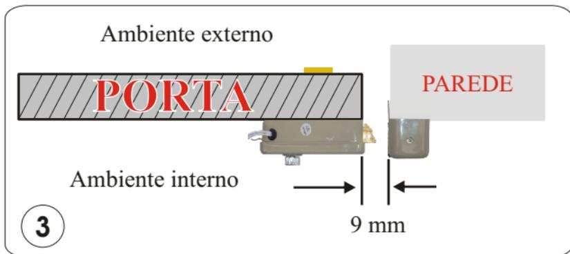
Verifique o local a ser colocada a fechadura antes de qualquer procedimento, faça o furo na porta/portão para o cilindro da chave, e monte conforme a figura acima.
